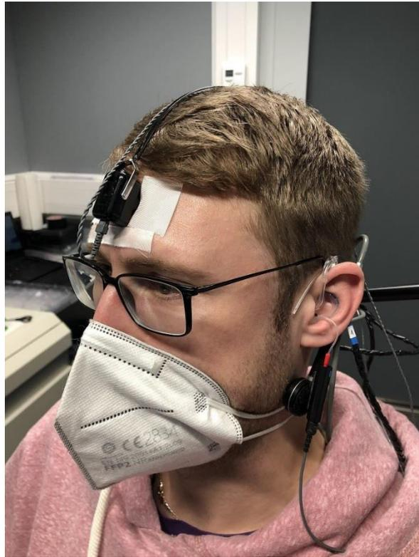
Abbildung 6.2: Zur Steigerung der Genauigkeit bei Repositionierung des Knochenleitungshörers wird dessen initiale Position auf der Stirn des Probanden mit Pflasterband markiert.
