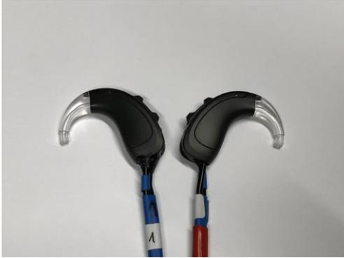
(a) Hörsystem-Dummy in HdO-Bauweise mit Anschlusskabeln zur Verbindung an das zugehörige Vorschaltgerät
