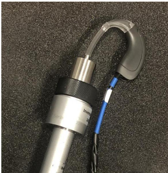
Abbildung 6.4: Kalibrierung von einem der beiden Hörsystem-Dummy-Hörer mithilfe eines Ohrsimulators. Hierbei wurden der zugehörige Ohrpasstück-Simulator und eine Schallschlauchlänge von 25,6 mm verwendet.
