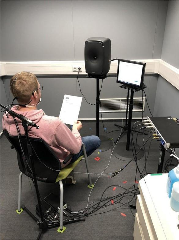
(a) Versuchsraum mit Proband. Auf der rechten Seite ist das Audio Interface, im Hintergrund der Freifeldlautsprecher, das 1/2"-Freifeldmikrofon und der Touchscreen-Monitor für Anweisungen an den Probanden zu sehen. Unter dem Stuhl des Probanden befinden sich Mikrofon-Speisegerät, Sondenschlauchmikrofon-System und das Vorschaltgerät für die Hörsystem-Dummies.
