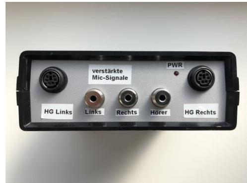
(b) Vorschaltgerät der Hörsystem-Dummies zur Verbindung an ein Audio-Interface per Klinkenstecker
