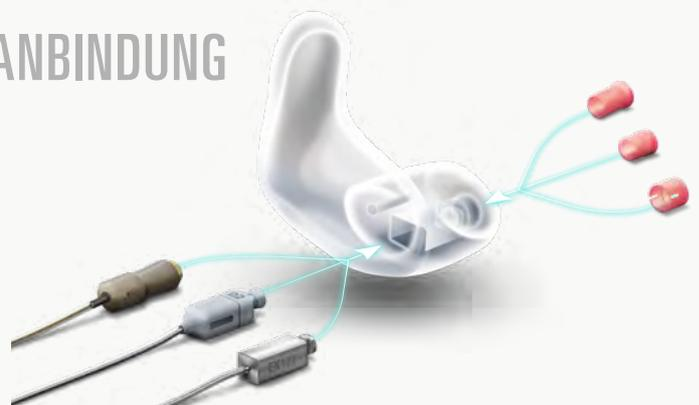
Für die Anbindung des Hörers an die Otoplastik hat Hörluchs® eine Bauform entwickelt, die jeden am Markt befindlichen S/M-Hörer aufnehmen kann. Möglich macht das die einzigartige Konstruktion der Höreraufnahme: Die Ex-Hörer werden per Steckverbindung mit Klickhülsen (den RIC-Adaptern) in der Otoplastik fixiert und können bei Bedarf gewechselt werden. Eine Verklebung ist nicht notwendig.
