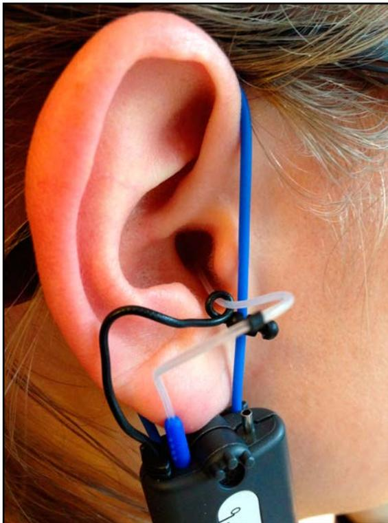
Abb. 3: Beispiel einer Fixierung/Abstandshalterung des Sondenschlauchs
