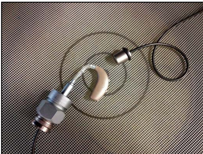
Abb. 3: Positionierung von Referenzhörgerät und Referenzmikrofon in der Messbox
