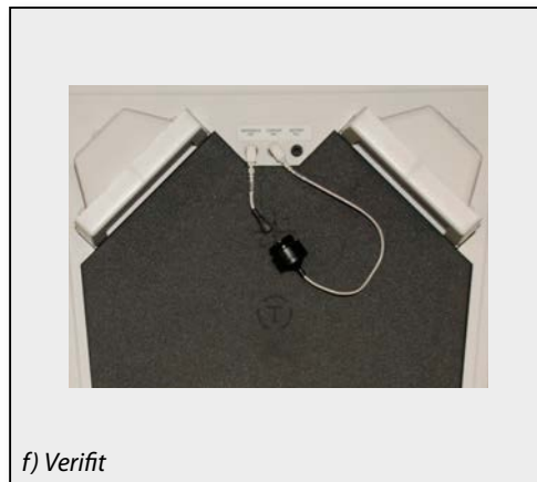
Abb. 2: Platzierung von Referenzmikrofon und Messmikrofon in den verschiedenen Messboxen
