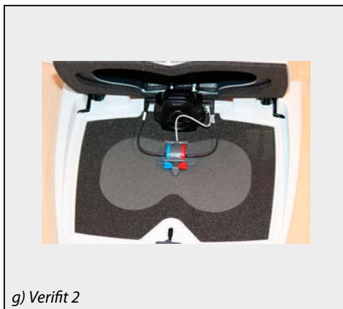
Abb. 2: Platzierung von Referenzmikrofon und Messmikrofon in den verschiedenen Messboxen
