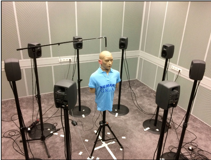
Abb. 5: Messaufbau in Messkabine mit binauraler Hörgeräteanbindung am KEMAR und Referenzmikrofon
