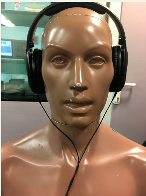
(c) Sitz der Sennheiser Kopfhörer HD 201 am Kemar
