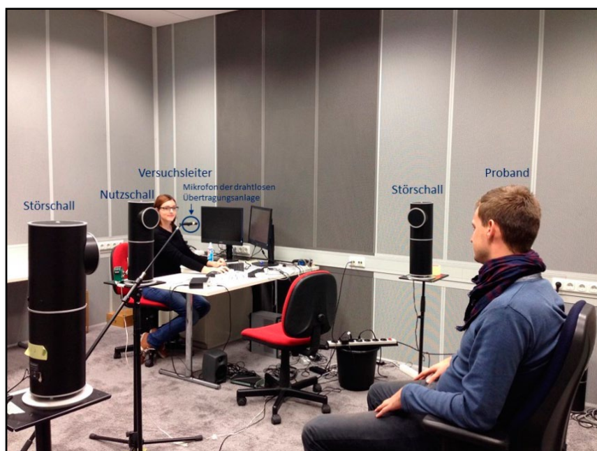
Abb. 3.1: Im Rahmen der Studie verwendeter Messaufbau. Der Proband sitzt in komfortabler Sitzhaltung frontal zum Nutzschaallautsprecher und mit Blickkontakt zum Versuchsleiter.
