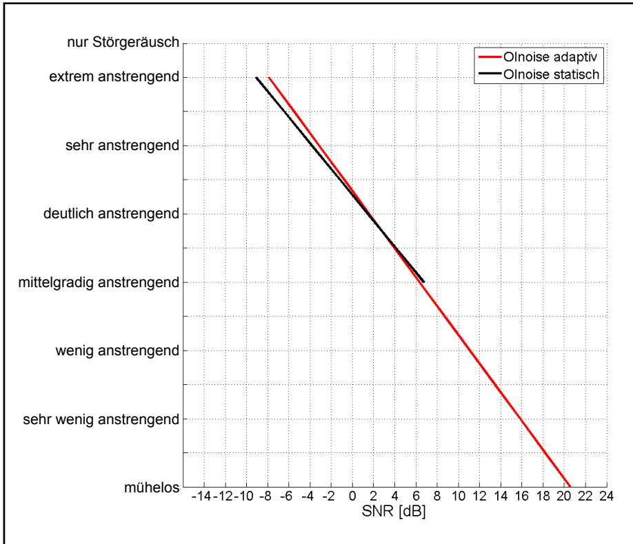
Abb. 4-4: Subjektive Höranstrengung einer Versuchsperson in Abhängigkeit vom SNR in dB ermittelt mit dem Maskierer Olnoise unter Verwendung der adaptiven (rote Linie) und statischen Messmethode (schwarze Linie)
