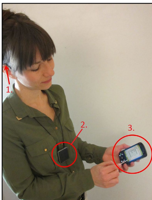
Abbildung 2.2: Aufnahmesystem zur Erfassung der Alltagssituationen mit objektiven und subjektiven Größen. Das System besteht aus vier Komponenten: 1. Zwei Hinter-dem-Ohr-Hörgeräte (Phonak Ambra Micro P), 2. Schnittstelle zwischen Hörgeräten und Smartphone (Phonak iCube), 3. Smartphone (HTC P3600).
