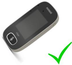
Pointing Modus = schräg = Adaptives Richtmikrofon
